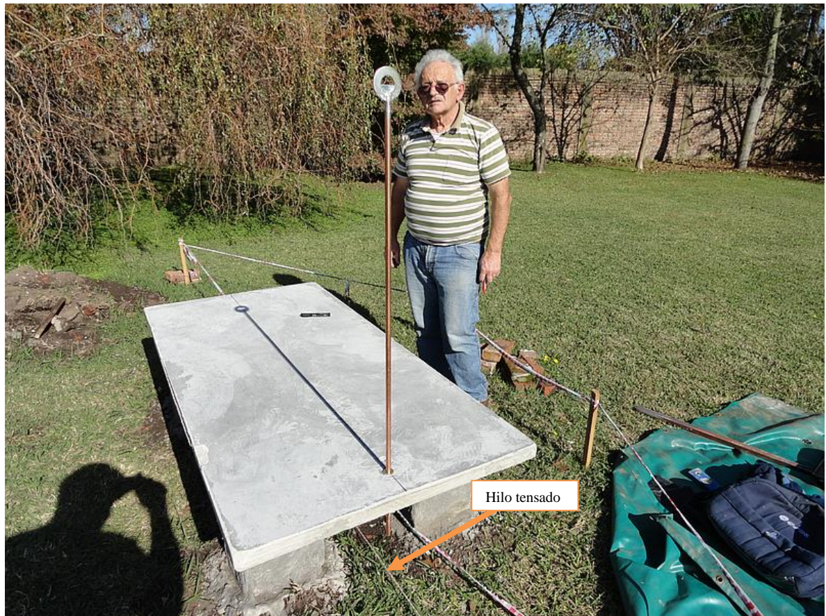
Se observa hilo tensado marcando la meridiana en plataforma
