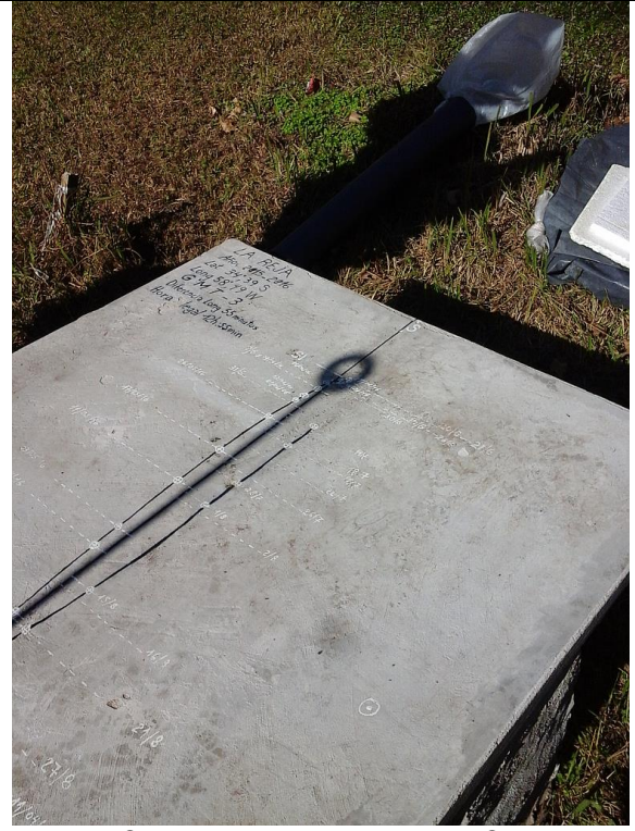
Sombra sobre meridiana TMSV ET = +2 , long.sombra 1,61m, decl.solar +23,48^\circ (SI) del 21/6/2016. Los datos tomados, son iguales al (SI) del año pasado 21/6/2015.
