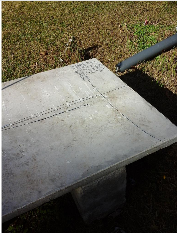
Curva proyectada por la sombra del gnomon, comienza 45 minutos minutos antes del paso por la meridiana donde finaliza 45 minutos despues , en el extremo este de la plataforma.
